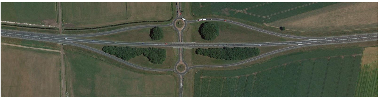
Figuur 17: Voorbeeldsituatie ongelijkvloerse kruising/Haarlemmermeeraansluiting
